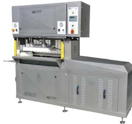
Una vez formateado el producto, el loncheado es regular desde el inicio al final de la pieza, obteniendo un óptimo rendimiento. Está construida totalmente en acero inoxidable AISI-304 con estructura de molde interior en acero inoxidable, formatos de moldes en material plástico, prensor superior de acero inoxidable y material plástico, programación, regulación y control del equipo hidráulico y formato de molde intercambiable para los diferentes tipos de producto a formatear.
