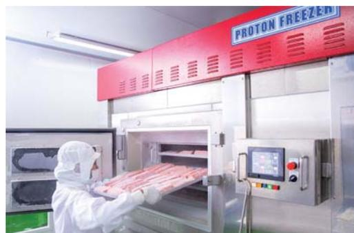
Mediante esta tecnología el producto se congela mientras un campo magnético estático y una onda eléctrica se irradian en una dirección predeterminada, evitando la expansión del volumen de cristales de hielo e inhibiendo tanto el cambio en el volumen de humedad como la destrucción de las células que contienen esa humedad en el momento de la descongelación, sin provocar pérdidas por goteo y manteniendo todas sus características organolépticas originales (sabor, textura, color,..).
