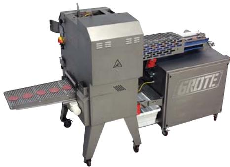
La cuchilla afilada de titanio corta con precisión todos los productos blandos con la ayuda de las vibraciones ultrasónicas de alta frecuencia, creando así una superficie libre de fricción.
