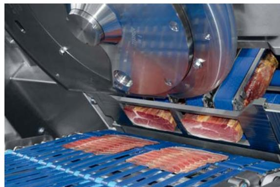
Uno de los aspectos más llamativos es el sistema de elevación servoaccionado diseñado específicamente para las demandas actuales de envasado de productos en rebanadas. El sistema de elevación
