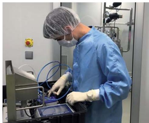
La auditoría de calidad del aire comprimido de **Beko Technologies** permite medir los valores exactos reflejados en la ISO 8573-1, partículas, humedad y aceite. Se realiza con los más modernos métodos de medición por parte de profesionales cualificados y tras la medición se entrega un informe completo.
