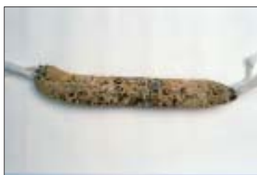
Figura 11. Precipitados de cloruro potásico.
