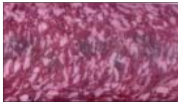
Figura 2c. Defectos de coloración seriados debidos a algún problema de embudidora (embarrado).
