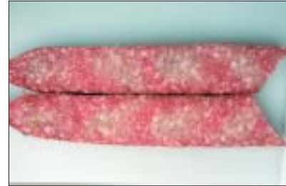
Figura 2b. Defectos de coloración seriados debidos a algún problema de embudidora (embarrado).
