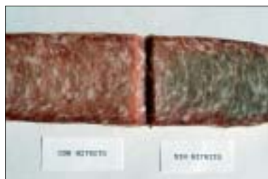
Figura 5b. Efecto de la adición de una solución de 0,1 g/l de nitrito a un embutido sin transformación de nitrato a nitrito.
