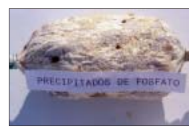
Figura 7c. Precipitados de fosfato.
